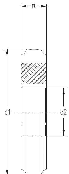
Fresa de perfil constante para estria (detalonada).
